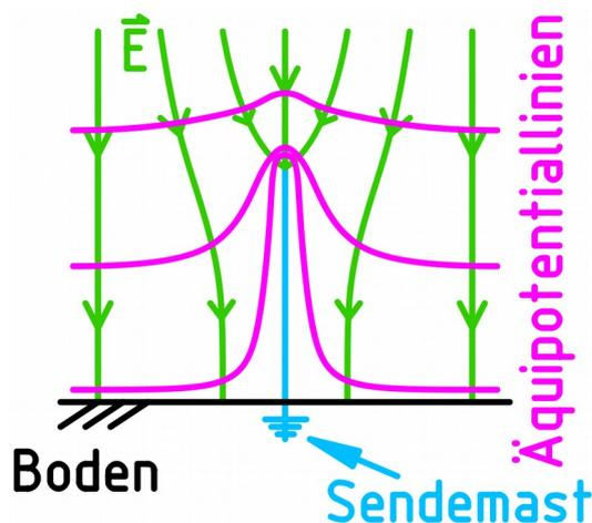
c) Die Außenhaut des Sendemastes aus Metall ist eine geerdete Äquipotentialfläche, deshalb liegt die Spitze des Sendemastes auf Erdpotential. Die senkrecht zu den Äquipotentiallinien verlaufenden Feldlinien werden so zur Spitze des Sendemastes hingezogen, wodurch im Bereich dieser Spitze ein deutlich stärkeres E-Feld entsteht, da die Feldlinien hier dichter sind. Ob es zum Spannungsdurchschlag kommt hängt nur von der Feldstärke ab, deshalb ist der Mast einschlaggefährdet.
