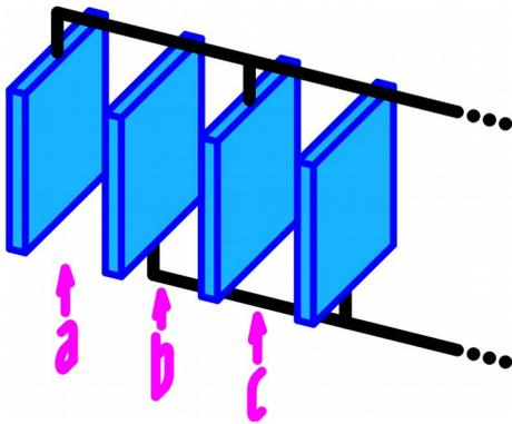
Solche Schaltungen kommen relativ häufig vor. Im Bild sind vier Plättchen so geschaltet, dass die drei parallel geschalteten Kondensatoren a, b und c entstehen. Man braucht also nicht für jeden Kondensator zwei separate Plättchen.
