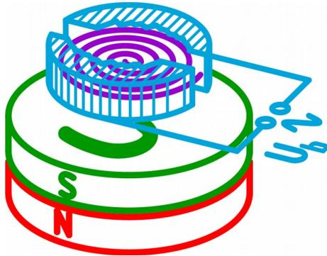
Es besteht aus zwei D-förmigen, hohlen Elektroden, den Duanten (blau), die an eine hochfrequente Wechselspannung angeschlossen sind und zusammen so was wie eine Dose bilden, innerhalb derer die spiralförmigen Teilchenbahnen (lila) laufen. Die Dose ist zwischen zwei starken Magneten (der obere fehlt in der Zeichnung) die im Bereich der Dose ein homogenes Magnetfeld erzeugen.
