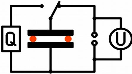
Zur Bestimmung der elektrischen Feldkonstante wird ein Kondensator benutzt. Dieser besteht aus zwei kreisförmigen Platten vom Radius 15 cm, die getrennt durch kleine Abstandshalter der Dicke 2,0 mm genau übereinander liegen. Der Kondensator wird auf verschiedene Spannungen aufgeladen und dann jeweils über ein Ladungsmessgerät entladen. Es ergeben sich die folgenden Messwerte.
