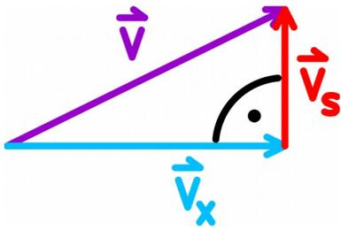
Die Protonen verlassen den Ablenkkondensator mit der Geschwindigkeitskomponente in x-Richtung  $v_x = 2000 \text{ km/s}$  und der Komponente senkrecht dazu  $v_s = 383 \text{ km/s}$ . Nach Verlassen des Kondensators treten die Protonen schräg zur Feldlinienrichtung in ein homogenes Magnetfeld ein, dass nur im gezeichneten Bereich auf die Protonen wirkt.
