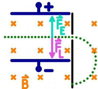
b) Kräftegleichgewicht:  $F_{el} = F_L \rightarrow E \cdot q = q \cdot v \cdot B \rightarrow E = v \cdot B \rightarrow v = \underline{\underline{\frac{E}{B}}}$
