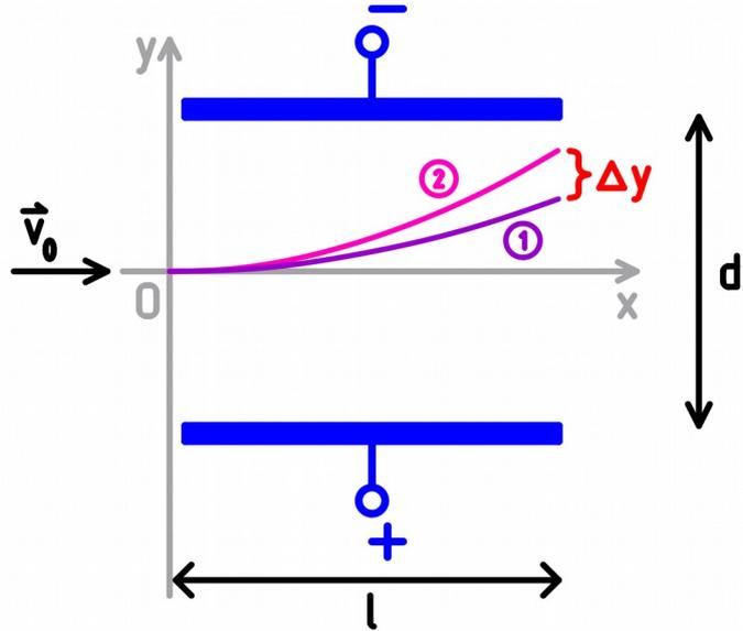
a) Berechnen Sie, welche Beschleunigungen die Ionen der Kohlenstoffisotope C12 und C14 durch das homogene Feld des Kondensators erfahren.
