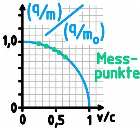
☺ Der Versuch von Kaufmann und Bucherer zeigt, dass die spezifische Ladung bei zunehmender Geschwindigkeit, in Übereinstimmung mit der Theorie, immer kleiner wird.
