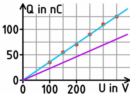
c) Durch das Verschieben wird die effektive Plattenfläche und damit die Kapazität verkleinert. Es ergibt sich eine Ursprungsgerade mit geringerer Steigung.
