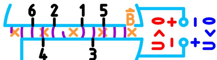
c) Ganz außen werden die Teilchen durch einen Kondensator auf eine geradlinige Bahn gebracht und aus der Apparatur entfernt. Zeichne die Pole der am Kondensator anliegenden Spannung ein.
