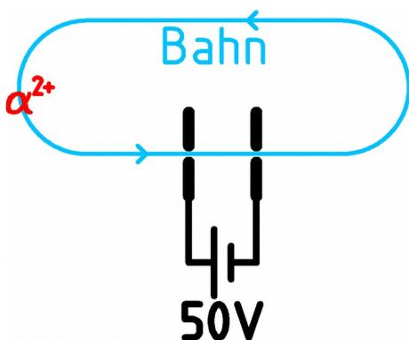
Ein Alphateilchen durchläuft auf seiner Bahn immer wieder einen durchlöcherten Kondensator der an eine Spannung von 50V angeschlossen ist.
