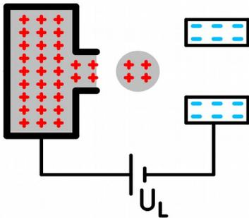
a) Die Tinte ist Bestandteil der linken Platte eines aus Tröpfchengenerator und Ringelektrode bestehenden Kondensators. Je größer die Spannung  $U_L$  am Kondensator, desto größer die Ladung auf den Platten also in der Tinte, desto größer die Ladung auf einem Tröpfchen.
