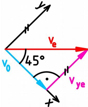
c) Damit die Geschwindigkeit beim Austreten aus dem Kondensator wieder exakt horizontal ist muss sie im Kondensator wieder um  $45^\circ$  gedreht werden. x- und y-Komponente der Endgeschwindigkeit bilden deshalb ein gleichschenkliges Dreieck in dem die Katheten gleich lang sind, also  $v_{ye} = v_0$ .
