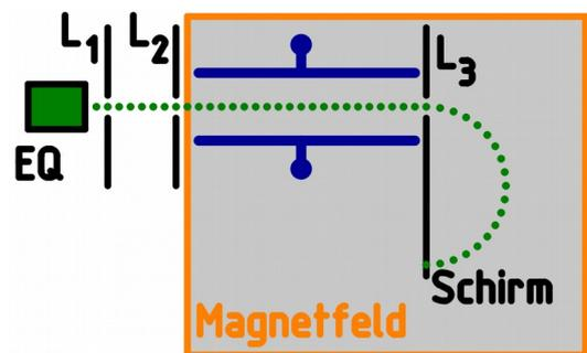
a) Erläutern Sie eingehend, warum man durch geeignete Wahl der beiden Felder erreichen kann, dass nur Elektronen einer bestimmten Geschwindigkeit den Kondensator geradlinig passieren und danach nach unten abgelenkt werden. Zeichnen Sie dazu die Orientierung des magnetischen Feldes und die Polung des Kondensators in die Abbildung ein.
