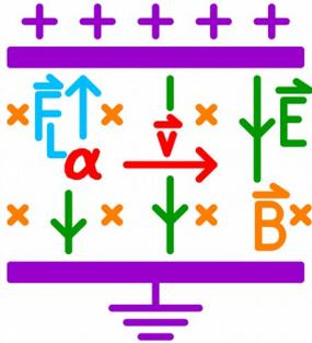
a) Wenn das B-Feld in die Zeichenebene hinein zeigt treibt die Lorentzkraft die Alphateilchen an die obere Platte. Dort streifen die Alphateilchen Elektronen ab und die Platte wird dadurch positiv geladen. Daraus resultiert ein elektrisches Feld und damit eine Spannung zwischen den Platten.
