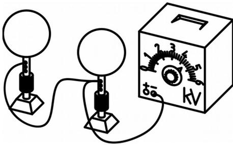
c) Zwei identische Kugeln mit Radius 10cm werden parallel an den Minuspol einer Spannung von 5,0kV angeschlossen. Die beiden Kugelmittelpunkte haben einen Abstand von 30cm. Jede Kugel hat eine Kapazität von 128 pF . Bestimme die Größe der Ladung auf jeder der Kugeln und mit Hilfe des Coulombschen Gesetzes
