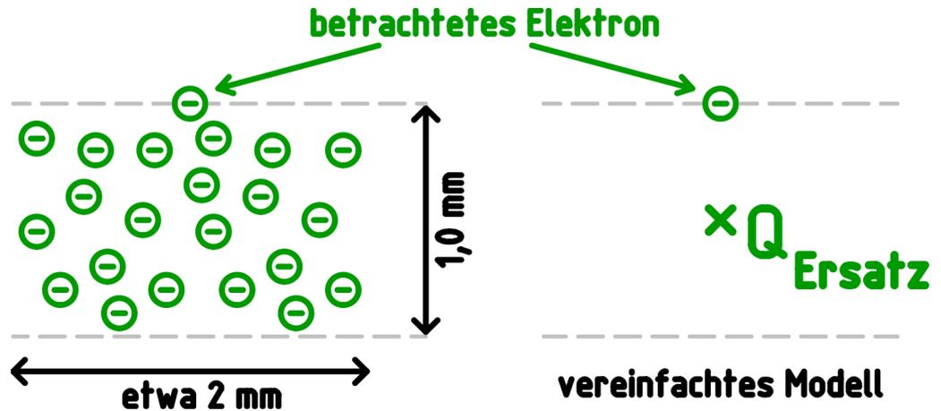
100 Elektronen bestehender Puls (Maße siehe Bild) betrachtet. Dazu berechnet man die Kraft auf ein einzelnes Elektron am Rand des Pulses, das von der Ersatzladung groß  $Q$  den Abstand  $\frac{1}{2} \cdot d$  hat. Die Ersatzladung (Wirkung der übrigen Elektronen ergibt sich näherungsweise durch die Gesamtladung der restlichen Elektronen in der Mitte des Pulses (siehe Bild).
