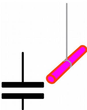
b) Man bringt eine leicht bewegliche negative Ladung - zum Beispiel einen Kunststoffstab, den man an Wolle oder einem Katzenfell gerieben hat und der an einem Faden aufgehängt ist - in die Nähe einer Platte. Wird die negative Ladung - der Kunststoffstab - angezogen, ist die Platte positiv geladen.
