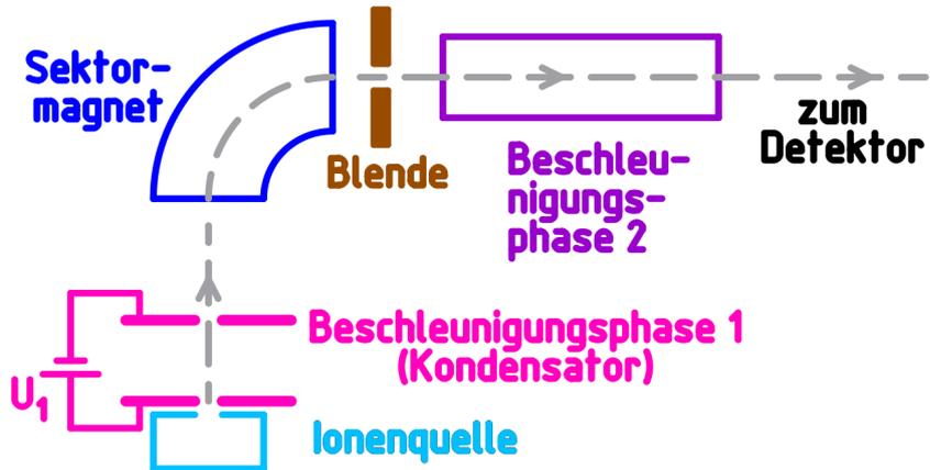
Die beschleunigten Ionen werden im Feld des so genannten Sektormagneten um  $90^\circ$  abgelenkt. Das als homogen angenommene Feld der Flussdichte  $B = 0,30 \text{ T}$  wird von einem Permanentmagneten erzeugt. Ionen, die sich auf einer Kreisbahn mit dem Radius  $r = 3,50 \text{ cm}$  bewegen, treten genau durch die Mitte der Blende nach dem Magnetfeld.
