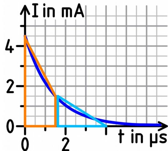
Auf diese Weise kann man also die aufgebrachte Ladung messen. Solche Flächen-Berechnungen werden durch elektronische Schaltungen realisiert, so dass man am Messgerät direkt die Ladung ablesen kann.
