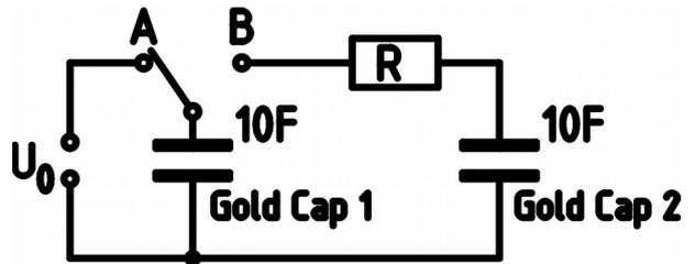
b) Die Spannung  $U_0$  wird auf 2,0 V eingestellt. Bestimmen Sie die Ladung  $Q_a$  des Gold Cap 1 und die Energie  $E_a$ , die in seinem elektrischen Feld gespeichert ist.
