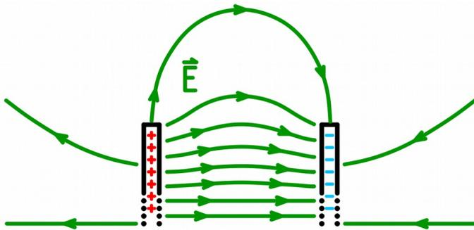
Das Bild zeigt die obere Hälfte eines Plattenkondensators und eine recht exakte Darstellung der Richtung und Stärke des E-
