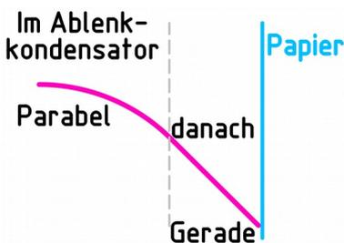
d) Im Ablenkkondensator folgen die Tröpfchen einer Parabelbahn. Außerhalb des Ablenkkondensators wirkt keine Kraft mehr auf die Tröpfchen und sie bewegen sich geradlinig mit konstanter Geschwindigkeit (Newton I).
