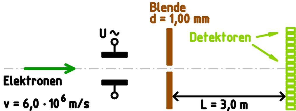
ein. An den Platten des Kondensators wird eine Wechselspannung  $U$  der Frequenz  $12 \text{ kHz}$  angelegt. Hinter dem Kondensator befindet sich eine Blende, deren Öffnung den Durchmesser  $d = 1,00 \text{ mm}$  hat. Im Abstand  $L = 3,0 \text{ m}$  hinter dieser Blende werden die Elektronen in Detektoren registriert (siehe Bild).
