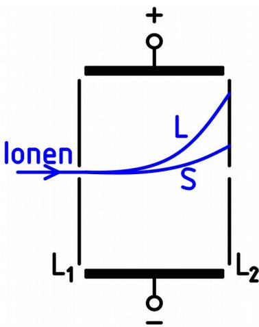
a) Das Isotop mit der kleineren Masse wird stärker beschleunigt, also mehr abgelenkt  $\rightarrow$  Bahn L gehört zu  $C_{12}$ , Bahn S gehört zum schwereren Isotop  $C_{14}$ .
