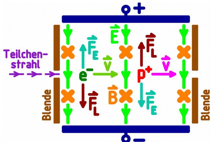
Über die elektrische Feldstärke (Spannung am Kondensator) und die magnetische Flussdichte lässt sich also die Geschwindigkeit der ausgefilterten Teilchen einstellen. Für sehr hohe Geschwindigkeiten ( $v \approx c$ ) braucht man extrem hohe elektrische Feldstärken oder recht kleine magnetische Flussdichten.
