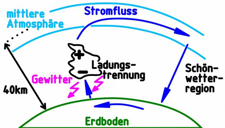
Die weltweite beobachtbaren Ströme in Schönwetterregionen können zu einem Gesamtstrom der Stärke  $I = 1,3 \text{ kA}$  zusammengefasst werden. Ohne anhaltende Ladungstrennung wäre bei Annahme eines konstanten Stromes  $I$  die mittlere Atmosphäre nach 14 Minuten entladen.
