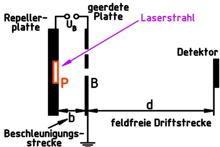
a) Berechnen Sie allgemein und nichtrelativistisch die Beschleunigungszeit  $t_b$  der Ionen für das Durchlaufen der Spannung  $U_b$  sowie die Flugzeit  $t_d$  auf der Driftstrecke bis zum Auftreffen auf den Detektor. Zeigen Sie, dass für die gesamte Flugzeit gilt:
