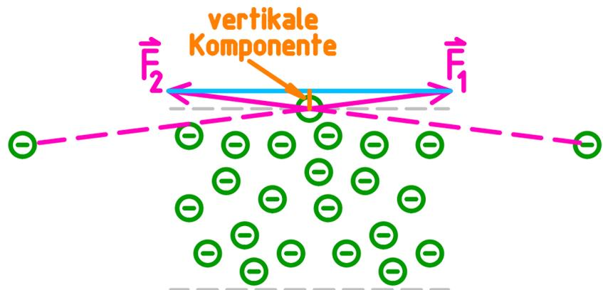
weiter entfernten Elektronen hauptsächlich in horizontale Richtung. Die Kräfte in horizontaler Richtung heben sich auf, weil auf der anderen Seite auch Elektronen sind. Es bleibt also nur eine sehr kleine Kraft in vertikaler Richtung, die viel kleiner ist, als die Kraft der Elektronen in dem betrachteten Puls.
