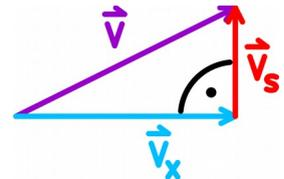
c) Berechnen Sie den Betrag der Geschwindigkeitskomponente  $v_s$  der Protonen beim Verlassen des Kondensators, wenn die Ablenkspannung  $U = 2,0 \text{ kV}$  beträgt. Unter welchem Winkel zur x-Richtung treten die Protonen in diesem Fall aus dem Kondensator aus? (Kontrolle:  $v_s = 383 \text{ km/s}$ )
