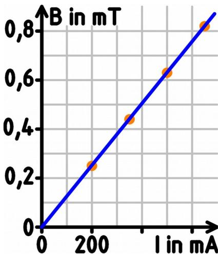
a) Wir tragen die Wertepaare in ein I-B-Diagramm ein. Da die Punkte sehr gut auf einer Ursprungsgeraden liegen, folgt die Proportionalität von  $B$  zu  $I$ .
