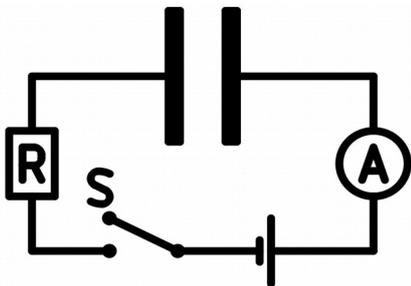
Zuerst messen wir die auf dem Kondensator liegende Ladung  $Q$  in Abhängigkeit von der anliegenden Spannung  $U$ . Zum qualitativen Nachweis von Ladungen kann man zum Beispiel ein Elektroskop nehmen. Für eine
