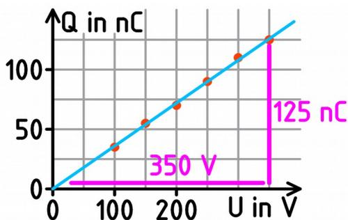
a) Wegen  $Q = C \cdot U$  ist  $Q$  direkt proportional zu  $U$  mit Proportionalitätskonstante  $C$ , deshalb gibt das  $U$ - $Q$ -Diagramm eine Ursprungsgerade mit Steigung  $C$ . Die Steigung im Diagramm ist also die Kapazität des Kondensators.
