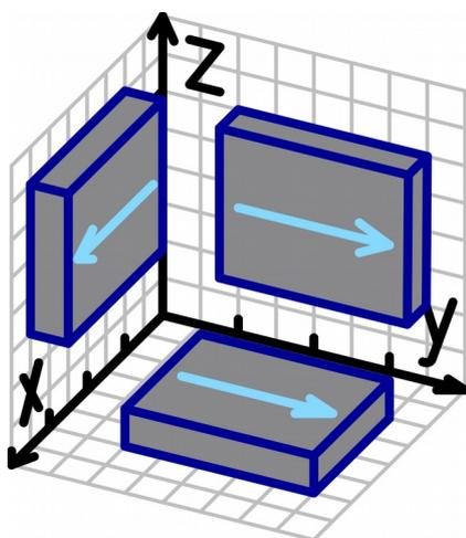
b) Das Bild zeigt drei Plättchen, die sich dazu eignen, die drei vektoriellen Komponenten der magnetischen Flussdichte zu messen. Welches Plättchen ist bei Benutzung der eingezeichneten Stromrichtung im Plättchen (siehe Pfeil) für welche Komponente der magnetischen Flussdichte ( $B_x$ ,  $B_y$  und  $B_z$ )? Zeichne auch bei jedem Plättchen die Kontakte für den Spannungsabgriff der Hallspannung ein. (Theoretisch sind mehrere Lösungen möglich, allerdings nur eine geschickte)
