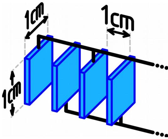
b) Die vier äquidistanten Plättchen im Bild stellen zusammen einen größeren Kondensator dar. Der Kondensator ist an eine Spannungsquelle mit Nennspannung  $U_0 = 5,0 \text{ V}$  angeschlossen.
