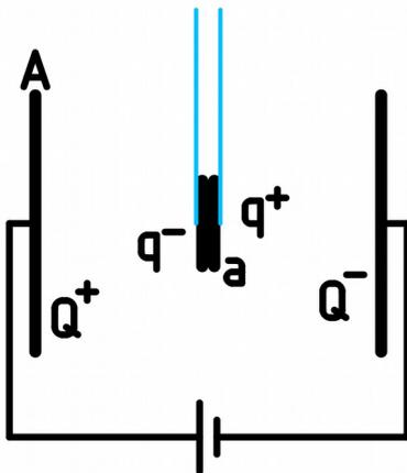
b) In den Kondensator bringt man zwei an Kunststoff-Stäben befestigte sich berührende Platten der Fläche  $a$ . Begründe, dass das durch die Influenzladung ( $-q$  und  $+q$ ) erzeugte E-Feld im Innern der kleinen Platten dieselbe Feldstärke besitzt wie das Feld des großen Kondensators und berechne die Größe der Influenzladung auf einer der kleinen Platten in Abhängigkeit der Feldstärke des großen Kondensators.
