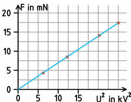
Die Kraft ist direkt proportional zu  $U^2$  mit der Proportionalitätskonstante  $k$ . Deshalb gibt das  $U^2$ -F-Diagramm eine Ursprungsgerade, insbesondere eine Gerade.
