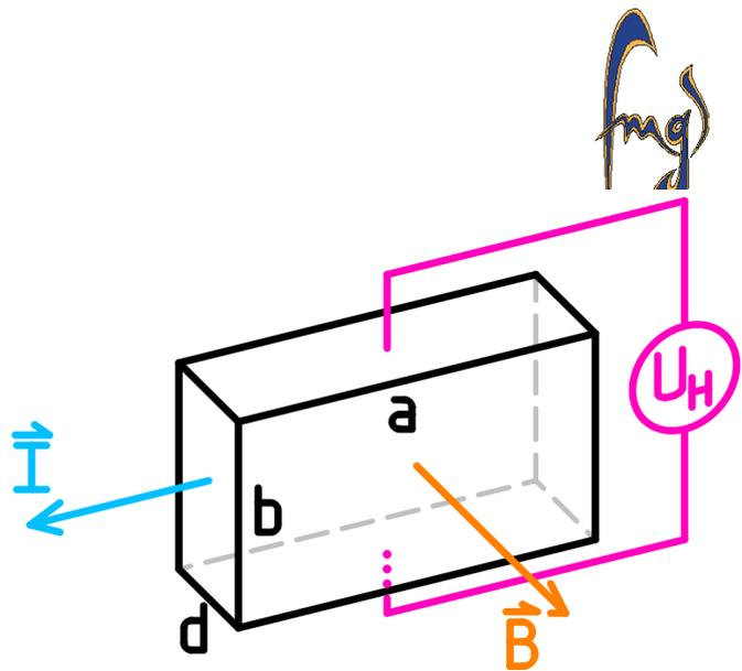
a) Leiten Sie aus einem geeigneten Kraftansatz die folgende Beziehung für die Hallspannung her:
