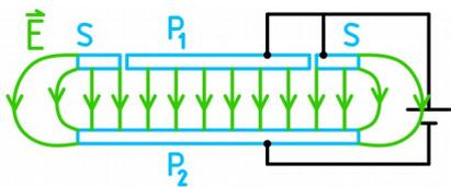
a) Durch den Ring wird das Feld im Bereich der oberen Platte sehr gut homogen. Inhomogenitäten am Plattenrand beeinflussen die Messung dann nicht mehr.
