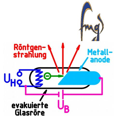
Die Beschleunigungsspannung  $U_B$  (hohe Gleichspannung: 10 kV bis 100 kV) dient dazu, die an der Glühkathode freigesetzten Elektronen in Richtung Anode zu beschleunigen, damit sie schließlich mit hoher Energie auf die Metallanode treffen.
