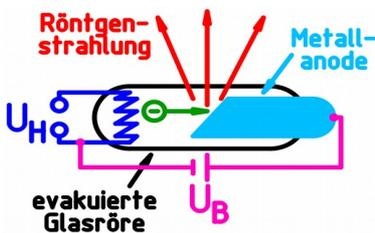
a) Die Heizspannung  $U_H$  ist eine kleine Wechselspannung, die Beschleunigungsspannung  $U_B$  ist eine große Gleichspannung (10kV - 150kV).
