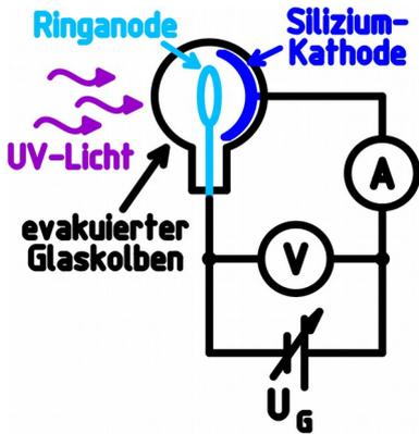
In einem Versuchsaufbau, der in nebenstehender Abbildung dargestellt ist, werden durch die Bestrahlung der Silizium-Kathode einer Vakuum-Fotozelle mit UV-Licht der Wellenlänge 302 nm Elektronen freigesetzt.
