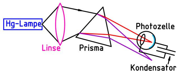
a) Fällt das Licht einer Quecksilberspektrallinie auf die Fotozelle, so wird der Kondensator auf eine bestimmte Spannung aufgeladen. Erklären Sie ausführlich das Zustandekommen der Spannung.
