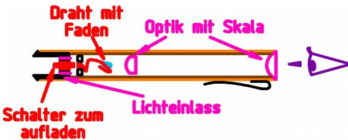
Vor der Benutzung muss das Stabdosimeter aufgeladen werden. Radioaktive Strahlung führt in der Kammer mit dem Draht zur Ionisierung und die Ionen entladen Draht und Quarzfaden, wodurch der Ausschlag des Fadens zurück geht.
