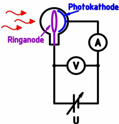
a) Das Bild ist ganz ähnlich wie die bekannte Schaltung zum Photoeffekt, nur dass man die Spannung anders polen muss, um die Photoelektronen zur Anode hin zu beschleunigen.
