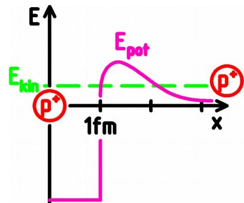
Wie ist es dann trotzdem möglich, dass ein Proton in den von der starken Wechselwirkung erzeugten Potentialtopf eines anderen Protons eindringen kann?
