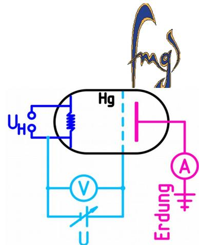
a) Ein Elektron habe gerade genug Energie, um kurz vor dem Anodengitter ein Atom anzuregen. Das Elektron verliert seine ganze kinetische Energie, wird aber danach wieder in Richtung Anodengitter beschleunigt. Weshalb kann es trotzdem die Auffangelektrode erreichen, obwohl es doch vom positiv geladenen Anodengitter angezogen werden sollte.
