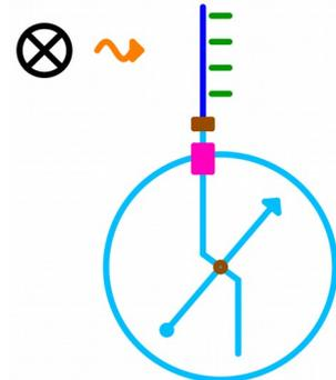
a) Bestrahlt man die negativ geladene Zinkplatte mit einer Quecksilberdampf Lampe, dann geht der Zeigerausschlag des Elektroskops sehr schnell auf Null zurück. Bestrahlt man die negativ geladene Zinkplatte jedoch mit einem leistungsstarken Tageslichtprojektor, dann lässt sich keine Auswirkung auf den Zeigerausschlag des Elektroskops beobachten. Erkläre die unterschiedlichen Reaktionen der Anordnung auf verschiedene Lichtquellen.
