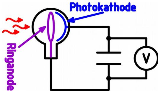
Eine Photozelle kann auch als Spannungsquelle dienen, z.B. um unter definierten Bedingungen ein Spannungsnormals als Vergleichswert zu liefern.
