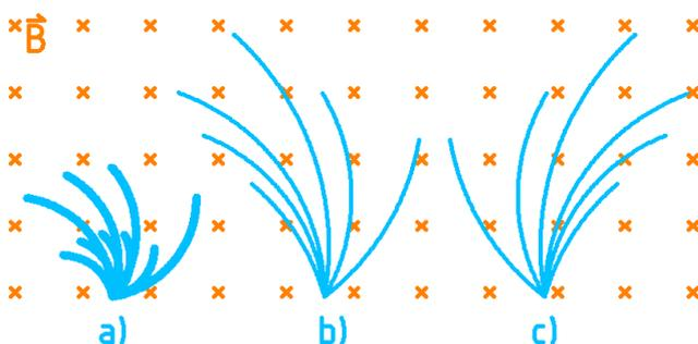
Die Nebelkammer ist von einem in die Zeichenebene hinein gerichteten Magnetfeld durchsetzt.
