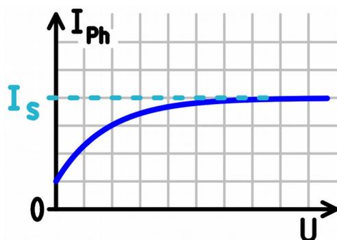
Eine Kalium-Photozelle (Auslösearbeit 2,25 eV) wird mit Licht der Wellenlänge 250 nm bestrahlt. Auf die Photokathode fällt dabei eine Lichtleistung von 1,2 W. Beim langsamen hochregeln der Saugspannung ergibt sich für den gemessenen Photostrom das nebenstehend gezeigte Diagramm mit einer Sättigungsstromstärke  $I_s$ .
