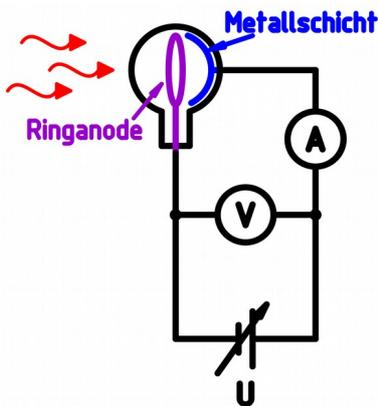
a) Mit dem Amperemeter rechts wird der Photostrom gemessen. Anschließend wird die Spannung (unten) solange hoch geregelt, bis der Photostrom zum Erliegen kommt. An diesem Punkt wandeln die Photoelektronen auf dem Weg zur Ringanode - im Gegenfeld - ihre ganze kinetische Energie in elektrische Energie um, dann gilt:
