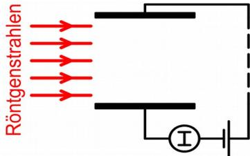
Richtet man die Röntgenstrahlung einer 35kV-Röhre zwischen die Platten eines mit Luft gefüllten Kondensators, an dem die Spannung  $U$  anliegt, so erhält man den skizzierten Zusammenhang zwischen  $U$  und dem Kondensatorstrom  $I$ .
