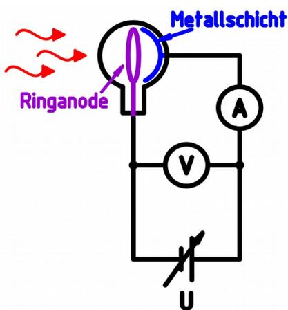
a) Die evakuierte Vakuum-Photozelle links oben wird mit monochromatischem Licht - bekannter Wellenlänge und Frequenz - bestrahlt, was dazu führt, dass am Amperemeter ein Photostrom gemessen wird. Anschließend wird die Gegenspannung so lange hochgeregelt, bis der Photostrom zum Erliegen kommt. Die entsprechende Gegenspannung wird am Voltmeter abgelesen und gibt mit  $e$  multipliziert die maximale kinetische Energie der Photoelektronen.
