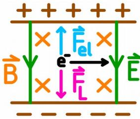
a) Magnetfeld (von Spule) und Elektrisches Feld (von Kondensator erzeugt) stehen senkrecht aufeinander. Lorentzkraft und elektrische Kraft auf ein nach rechts fliegendes Elektron haben genau entgegengesetzte Richtung. Nur solche Teilchen, bei denen die beiden Kräfte gleich groß sind, können den Geschwindigkeitsfilter nach rechts verlassen.
