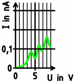
Das Bild zeigt das U-I-Diagramm einer Franck-Hertz-Röhre.
