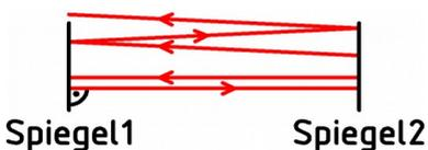
Auch die Lichtstrahlen mit der richtigen Wellenlänge, deren Richtung aber von der Senkrechten zu den Spiegeln abweicht verlassen den Resonator recht schnell.
