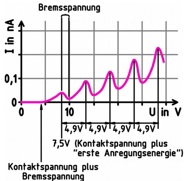
Außerdem fließt bei ganz kleinen Beschleunigungsspannungen gar kein Strom. Erst wenn die Beschleunigungsspannung größer ist, als die Kontaktspannung werden Elektronen beschleunigt und erst wenn sie genug kinetische Energie haben um die Bremsspannung zu überwinden kann ein Strom gemessen werden. Bei vielen real aufgenommenen Messkurven, die Sie im Internet finden ist dieser Effekt nicht zu sehen, das liegt aber an Störeffekten und unvermeidlichen Messfehlern.
