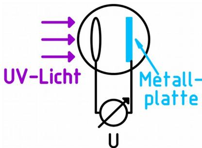
Bei der skizzierten Vakuumphotozelle zeigt das extrem hochohmige Voltmeter nach dem Einschalten der Beleuchtung die im Diagramm dargestellte zeitlich abhängige Spannung.
