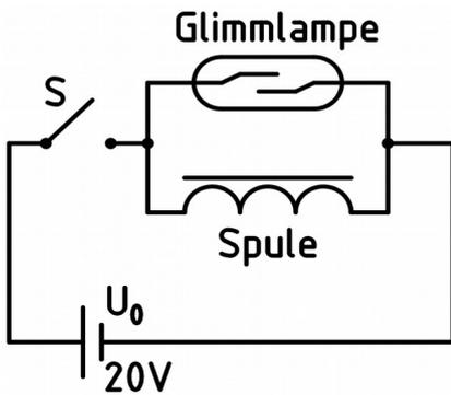
Wie in der Abbildung skizziert, werden eine Glimmlampe (Zündspannung ca. 100 V) und eine Spule mit sehr großer Induktivität  $L$  und einem ohmschen Widerstand von  $280 \Omega$  über einen Schalter  $S$  an eine Stromquelle mit 20 V Spannung angeschlossen.
