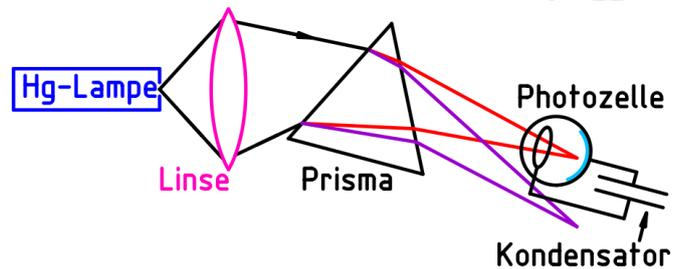
a) Fällt das Licht einer Quecksilberspektrallinie auf die Fotозelle, so wird der Kondensator auf eine bestimmte Spannung aufgeladen. Erklären Sie ausführlich das Zustandekommen der Spannung.
