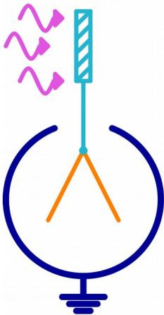
Hallwachs belichtete eine mit einem empfindlichen Goldblatt-Elektroskop verbundene Metallplatte mit UV-Licht. Er beobachtete eine sofort einsetzende Abstoßung der beiden Goldblättchen bis zu einer maximalen Auslenkung, die sich auch bei weiterer Bestrahlung mit dem gleichen Licht nicht mehr änderte.
