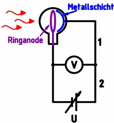
Dazu legen wir zwischen Metallschicht (Photokathode) und Ringanode eine Gegenspannung an, die mit einem Voltmeter gemessen wird. An der Stelle 1 oder 2 schließen wir ein Amperemeter an. Jetzt regeln wir die Spannung so lange hoch, bis kein Photostrom mehr fließt. Bei diesem Wert für die Spannung wird die kinetische Energie der Photoelektronen vollständig in elektrische Energie umgewandelt. Dann ist
