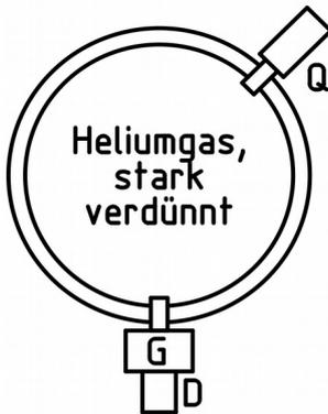
Eine Quelle Q emittiert einen Strahl von Elektronen. Diese treten mit der einheitlichen Geschwindigkeit  $v_0 = 3,75 \cdot 10^6 \text{ m/s}$  in einen Behälter ein, wo sie mit stark verdünntem Helium-Gas wechselwirken können. Mit Hilfe eines Geschwindigkeitsfilters G und eines Detektors D wird das Geschwindigkeitsspektrum der Elektronen untersucht, die unten aus dem Behälter austreten.
