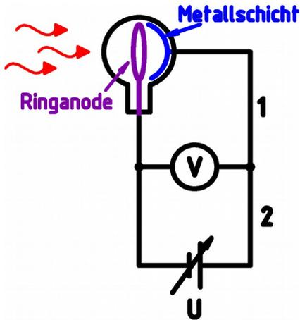
Bei der Messung muss man ganz genau wissen, wann der Photostrom Null wird. Der Photostrom wird in der Schaltung bei 1 oder 2 gemessen.
