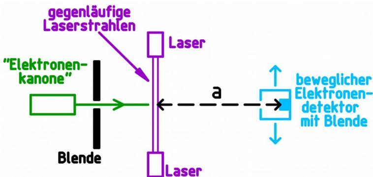
Im skizzierten Versuchsaufbau erzeugen zwei sich überlagernde, gegenläufige Laserstrahlen ( $\lambda = 532 \text{ nm}$ ) ein "Lichtgitter" mit hoher Photonendichte. Ein Strahl von Elektronen mit der kinetischen Energie  $E = 380 \text{ eV}$  trifft senkrecht auf die Laserstrahlen.
